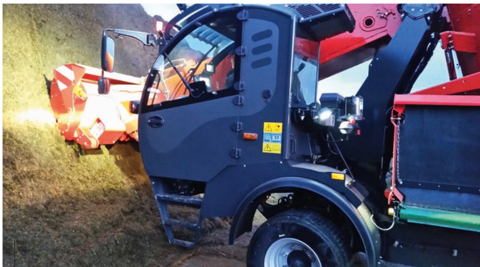
Una soluzione per monitorare costantemente i parametri della razione (umidità, proteina, fibra, lipidi e ceneri) è rappresentata dall'installazione del sensore Nir di Dinamica Generale nella testata di fresatura del carro miscelatore.
