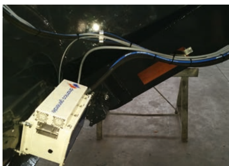
Il "dg precisionFeeding" realizzato dalla mantovana Dinamica Generale è un kit costituito da un analizzatore Nir, un software di gestione dell'alimentazione e un indicatore di peso.
