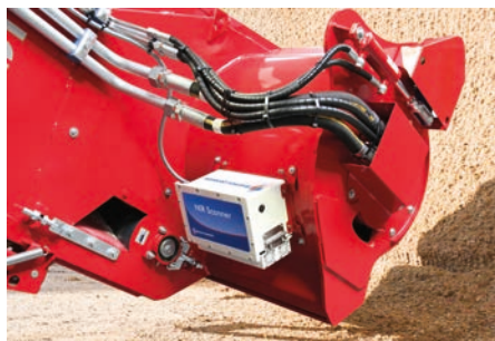
Dinamica Generale fornisce anche la tecnologia alla base del funzionamento del sensore montato da Siloking sui propri carri miscelatori semoventi.
