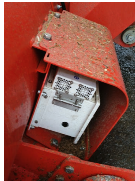
Una soluzione per monitorare costantemente i parametri della razione (umidità, proteina, fibra, lipidi e ceneri) è rappresentata dall'installazione del sensore Nir di Dinamica Generale nella testata di fresatura del carro miscelatore.
